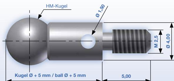
Kontur bei Kugel Ø ≤ 4,000 / ball counter Ø ≤ 4.000
