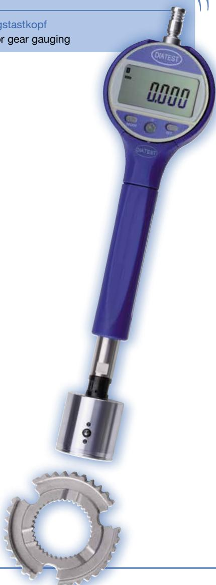
Ab dem Maß Mi=26,0 mm kann das Messkopfsystem eingesetzt werden. Die Messköpfe der Baureihe MK6 –ZM6 und MK7-ZM7 haben einen beweglichen Messkontakt (KT-ZM-...) und einen festen (KS-ZM67-...). Die Anpassung an das entsprechende Maß Mi erfolgt über Zwischenverlängerungen (ZS-A bis ZS-E-Plus) und über verschiedene lange Kugelschrauben (KS-ZM67-0 bis KS-ZM67-4). Die Zusammensetzung des Messkopfes kann den Tabellen der 212 und 213 entnommen werden.
