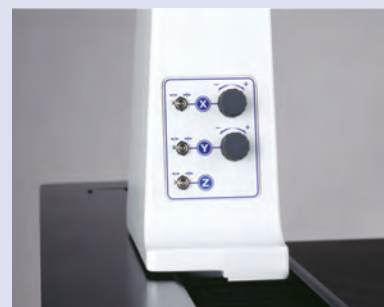
Vippbrytare för luftläsning och finmatning för snabb och enkel positionering
