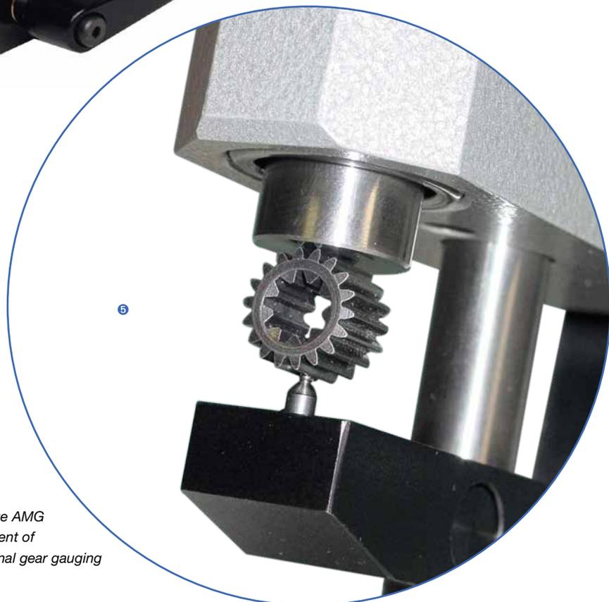
4 Außenmessgerät AMG External diameter gauge AMG
