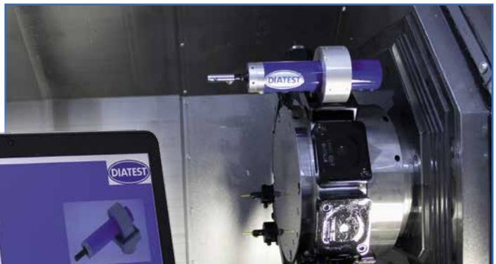
BMD in CNC-Drehmaschine
